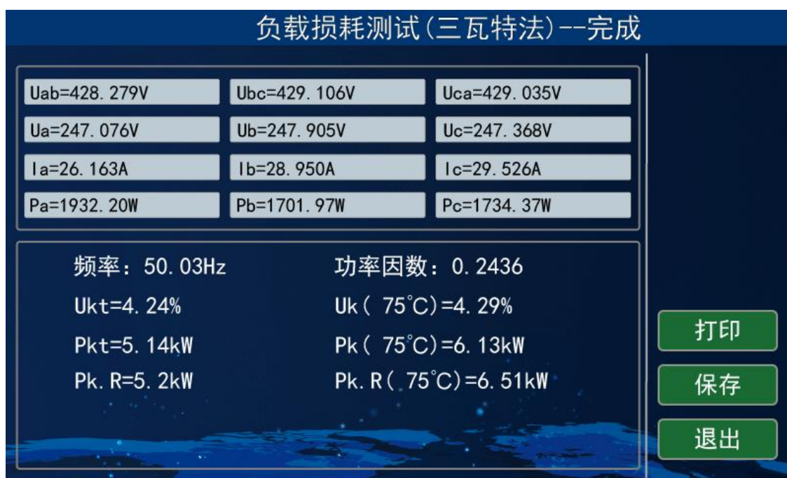
图 13-2 三瓦特法负载损耗测试结果
