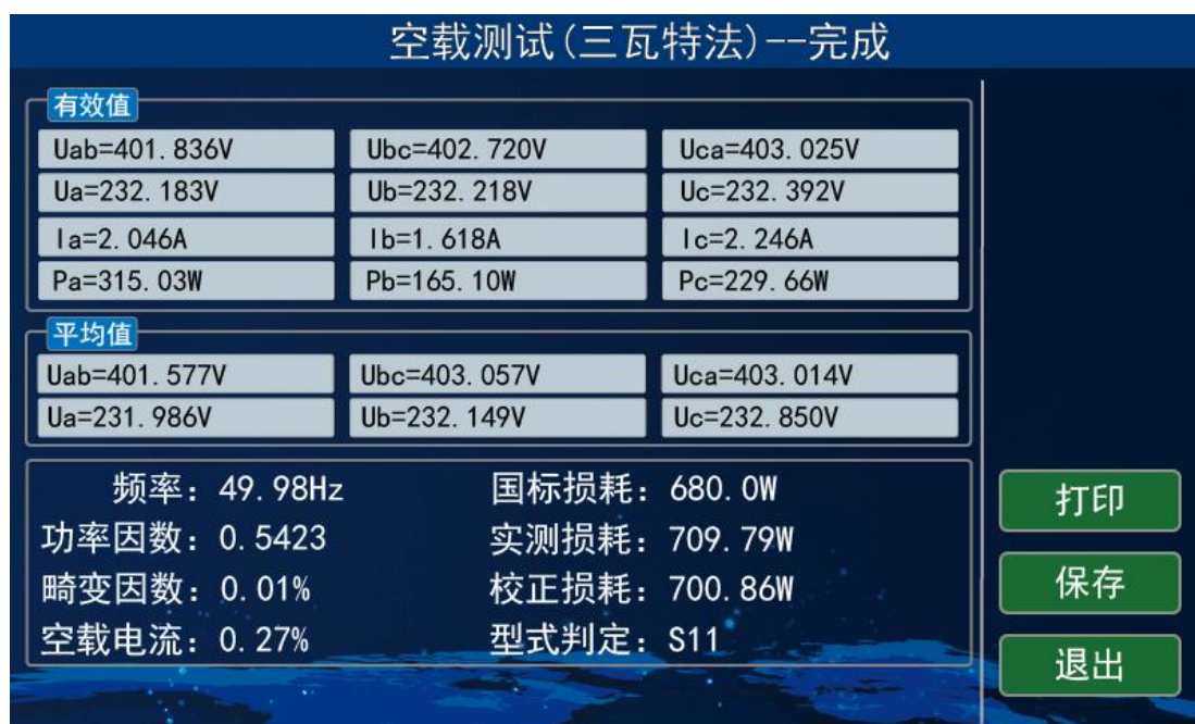
图 9-2 三瓦特法空载测试结果
