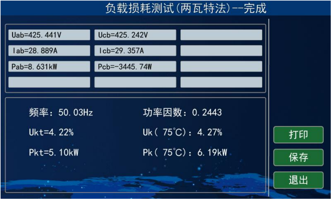
图 14-2 两瓦特法负载损耗测试结果
