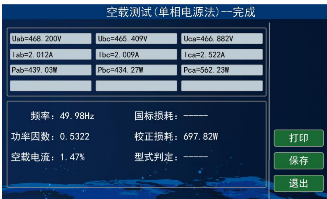
图 11-3 单相电源空载测试 CA 相
